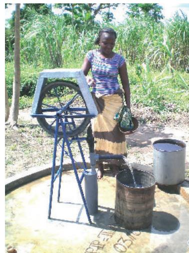
*Extracción de agua con bomba de mecate*
